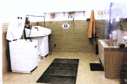
A gauche, les machines de lavage des rouleaux et pinceaux ainsi que celle destinée à collecter, sécher et compacter les impuretés. A noter les grilles qui permettent de récupérer les eaux usées.
